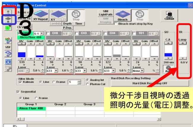
微分干渉目視時の透過照明の光量(電圧)調整。
